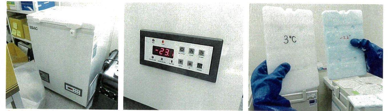
23 モデルナ用の冷凍機庫 24 モデルナの場合温度は-15°C～-25°Cに維持 25 保冷剤も温度別に色を分けて使用
