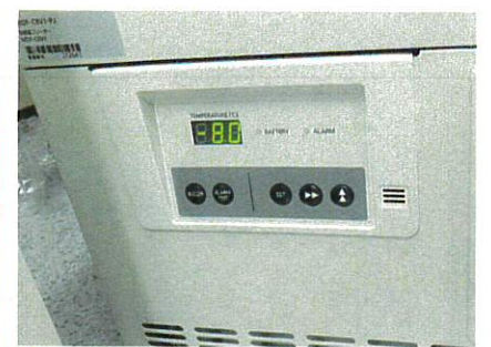
⑪ 冷凍庫の温度を確認
